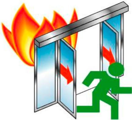
Sollten die Break-Out-Flügel nicht jederzeit begehbar sein, muss die Fluchtfunktion mit einem Handtaster und einer Handentriegelung sichergestellt werden (siehe System 2). Diese Anwendung muss von den zuständigen Behörden (Gebäudeversicherung, etc.) genehmigt werden. Eine flüchtende Person versteht evtl. nicht, dass zuerst der NOT-AUF und anschliessend noch Drücker oder Pushbar betätigt werden müssen.
