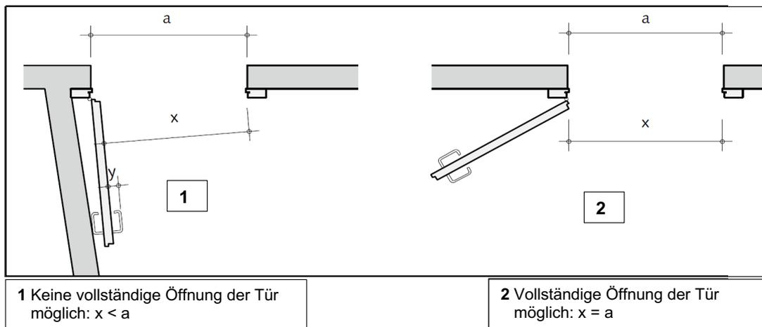
$a$  Rahmenlichtbreite (entspricht lichter Öffnungsweite des Rahmens  $\langle a \rangle$ )
